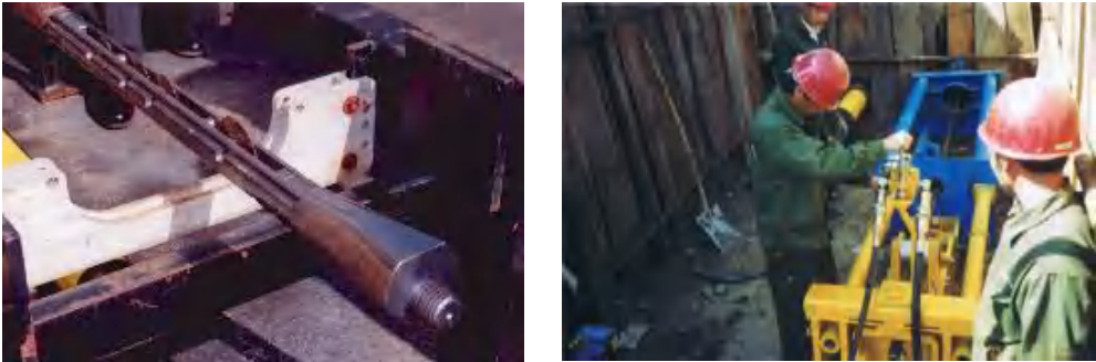
图 2-32 碎裂管工具与设备
