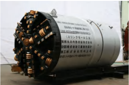
图 2-11 铣磨式顶管掘进机
