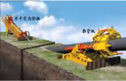
图 2-20 推管机用于辅助回拖作业
