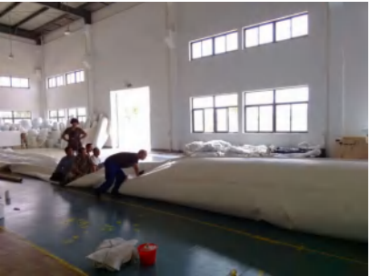
图 2-29 上海管丽公司大直径 CIPP 管道修复
