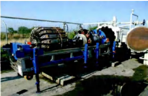
图 2-39 LineExplorer 3TM-tool 电磁超声检测器
