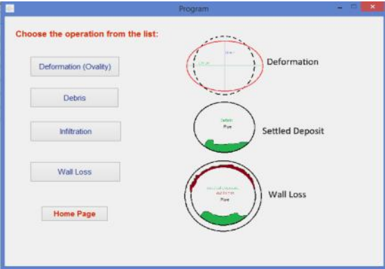
图 2-46 加拿大 Concordia 大学多属性下水道评价模型
