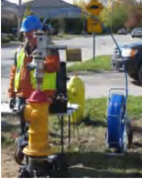
图 2-42 典型的小直径 CCTV/声学检测装置
