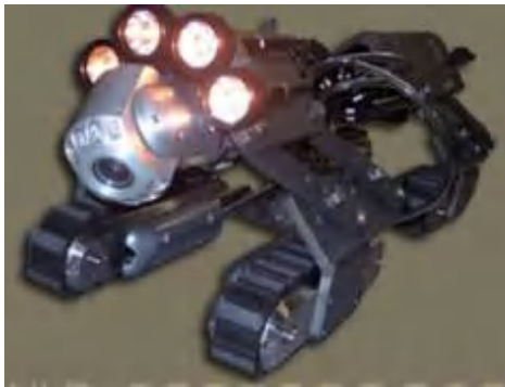
图 2-41 轮式及履带式摄像检测车
