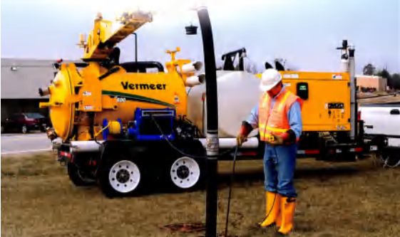
图 2-34 美国威猛公司 V800 真空挖掘机
