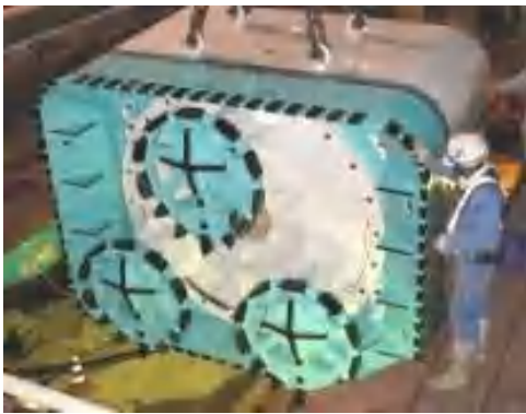
图 2-10 日本 Alpha 土木工程公司矩形顶管掘进机
