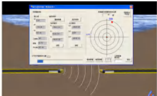
图3.10 导向孔对接示意图
