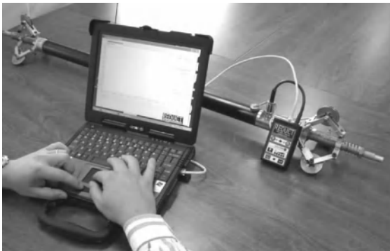
图 2-35 DUCT RunnerTm DR-HDD-4.2 惯性陀螺定位仪
