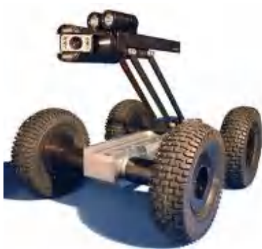
图 2-41 轮式及履带式摄像检测车
