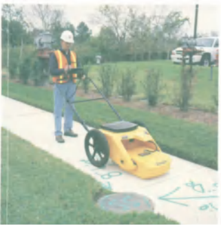
图 2-33 美国威猛 Interragator II 探地雷达
