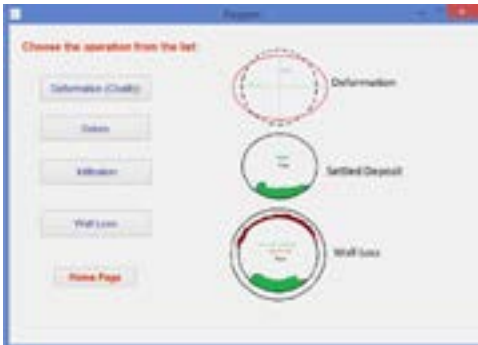
图 2-73 加拿大 Concordia 大学多属性下水道评价模型
