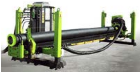
图 2-13 芬兰 Geonex 公司的潜孔锤钻机
