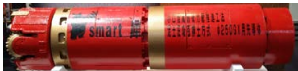
图 2-19 日本 250mm 微型顶管机
