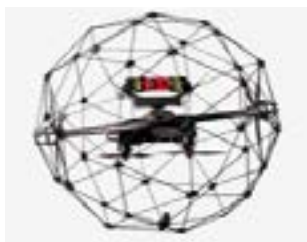
图 2-63 无人机检测设备
