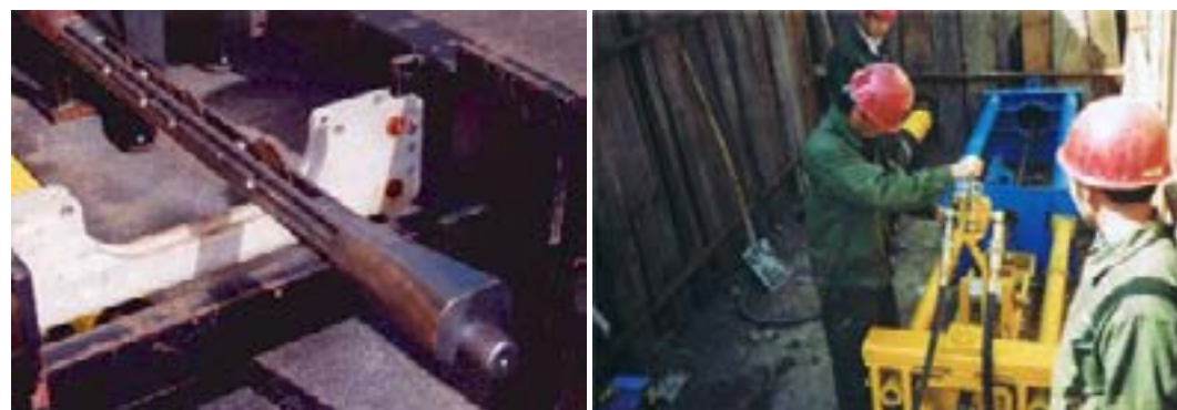
图 2-44 碎裂管工具与设备
