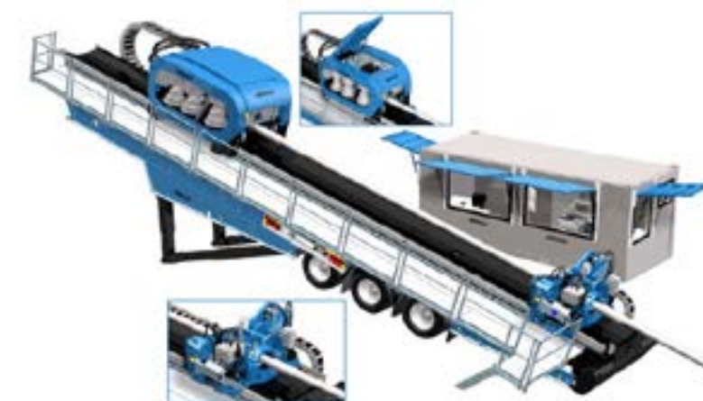
图 2-5 意大利 EGT 公司研制的电池驱动钻机
