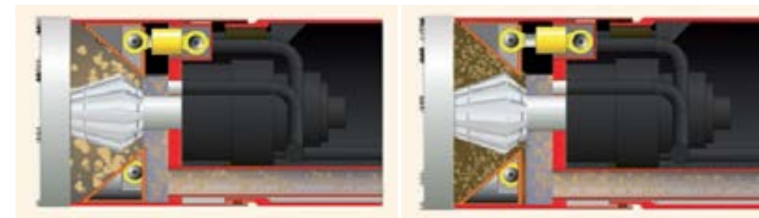
图 2-22 大破碎间隙（粘性土）
