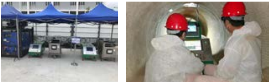
图 5-3 小型分离式固化设备
