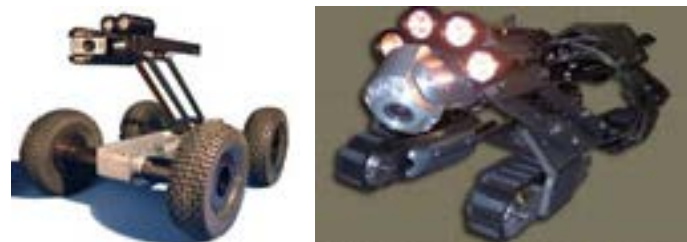
图 2-57 轮式及履带式摄像检测车
