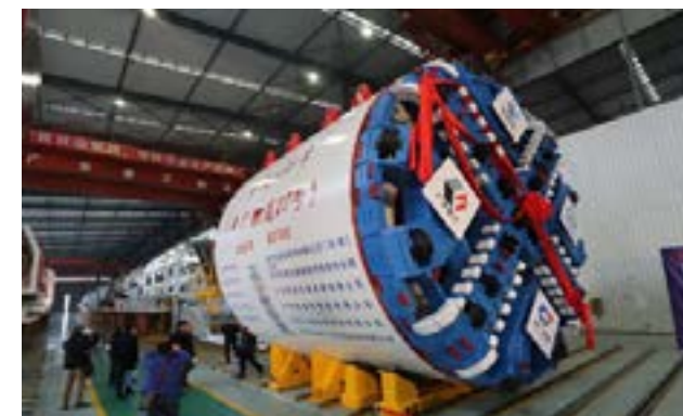
图 2-36 “中铁 685 号”气垫式直排泥水 - 土压双模盾构机
