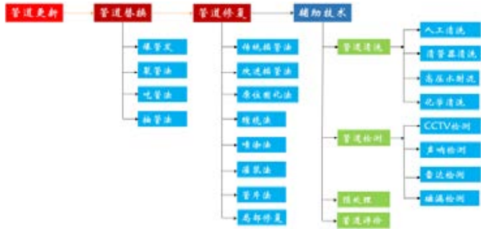
图 1-2 非开挖管道更新工法分类
