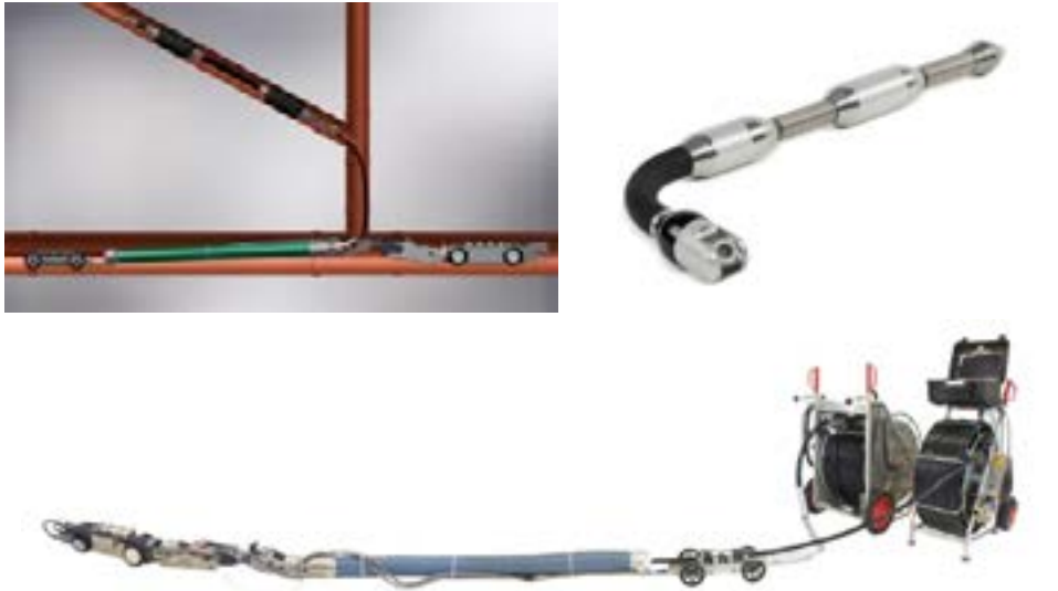
图 2-66 德国机器人公司的微型系统 / 污水分支管道机器人
