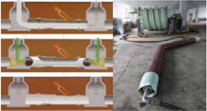
图 2-48 热塑料成型工法与试验
