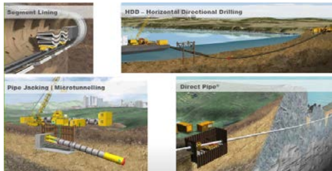
图 2-43 海岸管道工程施工方法
