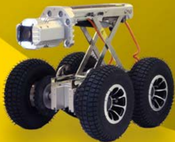
地下管道检测机器人 FB20x
