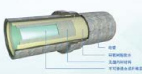
管道修复结构图
