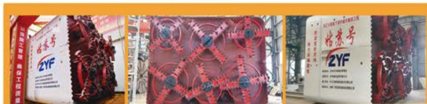
6.9*5.0m多刀盘土压平衡矩形顶管机
