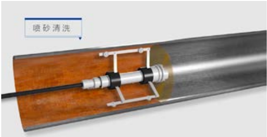
图 6 喷砂清洗示意图
