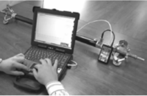
图 2-54 DUCT Runner™ DR-HDD-4.2 惯性陀螺定位仪
