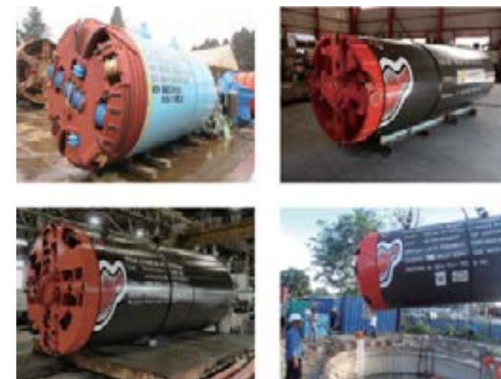
图 2-24 刀盘可转化的顶管机
