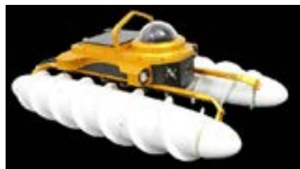
图 2-62 螺旋推进式 CCTV 检测设备
