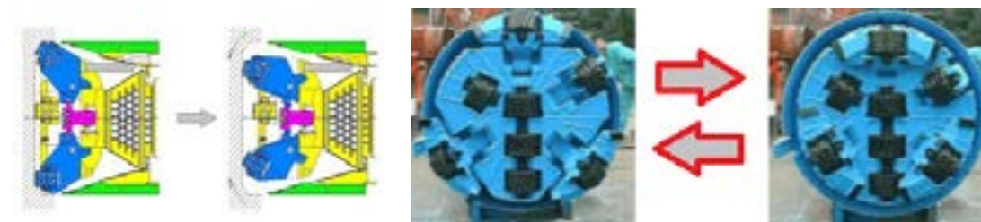
2-23 可撤回的顶管机机头
