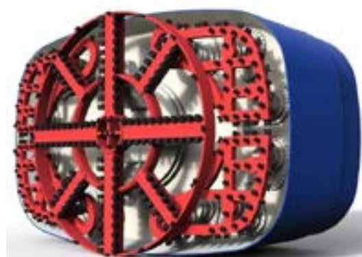
图 2-21 上海隧道股份路桥集团矩形顶管机
