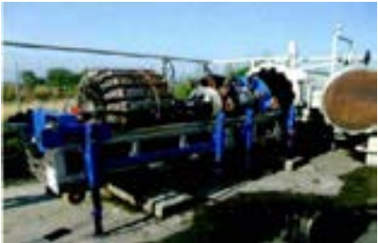
图 2-67 LineExplorer 3TM-tool 电磁超声检测器
