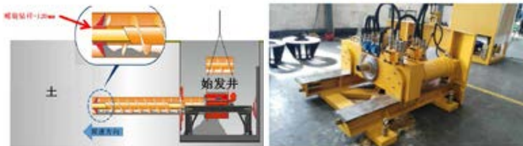
图 2-29 管幕顶管工作示意图
