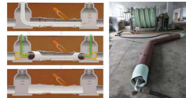
图 2-74 热塑料成型工法与试验
