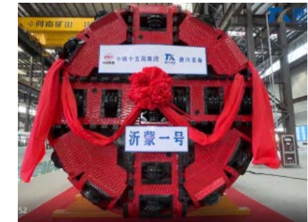
图 2-61 安徽唐兴沂蒙一号小直径硬岩泥水平衡盾构机
