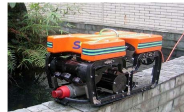
图 2-95 ROV Seamor 型潜水检测机器人
