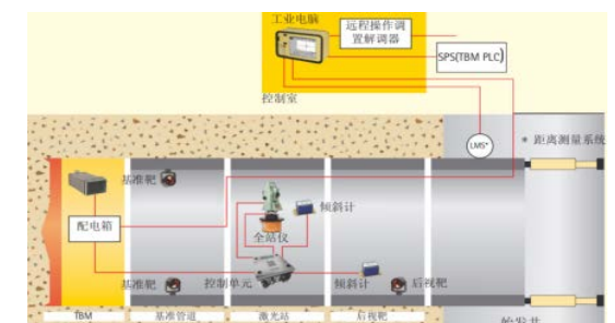
图 2-43 德国 SLS-RV 顶管导向系统
