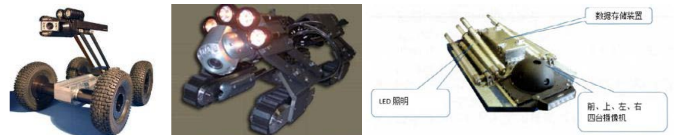
图 2-93 轮式与履带式 CCTV 检测车
