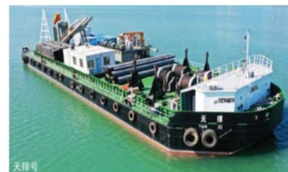
图 2-7 廊坊华元“天择号”HDD 专用钻探船
