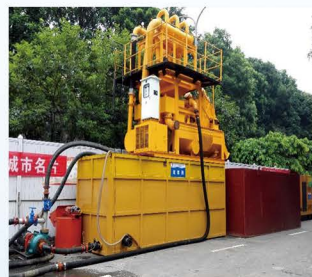
ZX-250用于顶管工程
