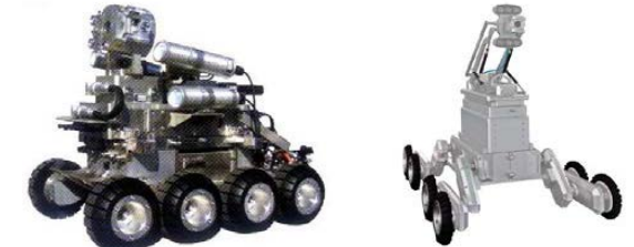
图 2-96 大型 CCTV 检测设备
