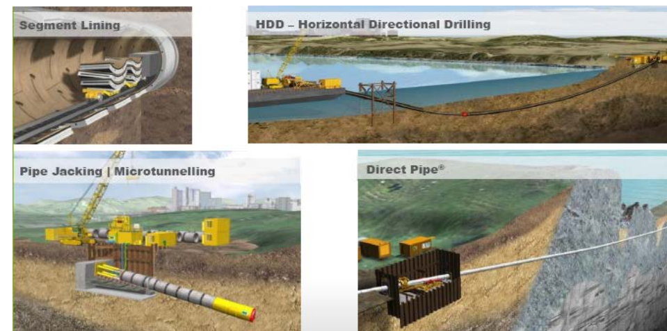
图 2-71 海岸管道工程非开挖施工方法
