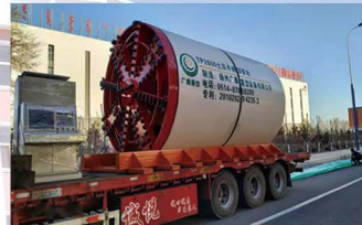
DN2600土压平衡顶管机
