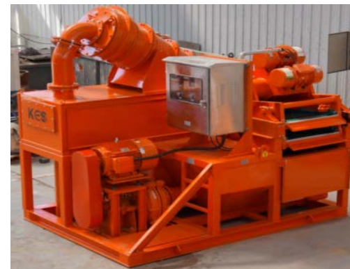
图 2-14 科盛能源泥浆泥水分离系统
