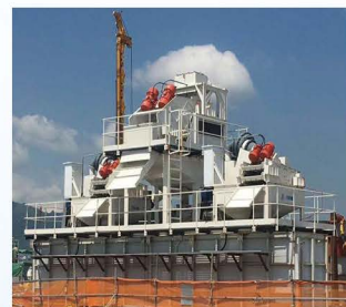
ZX-500用于顶管工程
