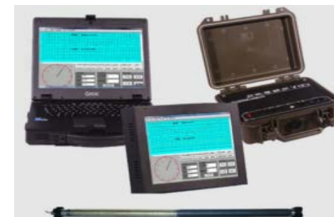
图 2-20 河南华北 CDY2 有线地磁导向仪
