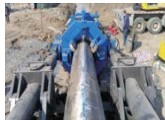
图 2-67 无锡钻通 ZTTG-500 推管机
