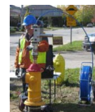
图 2-99 典型小直径 CCTV / 声学检测装置
