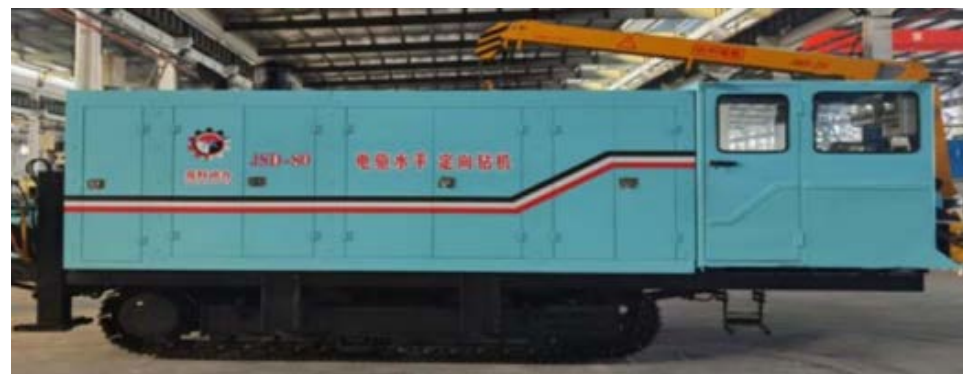
图 2-1 江苏竞科永磁电动直驱钻机
