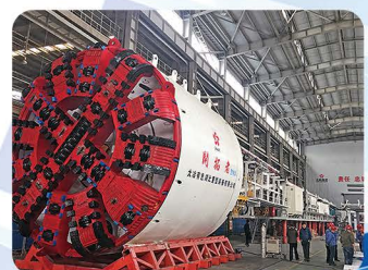
D6420mm土压平衡盾构机
