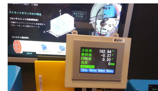
图 2-42 日本光纤陀螺顶管导向系统
