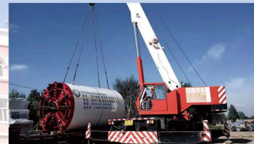
DN2400土压平衡顶管机
