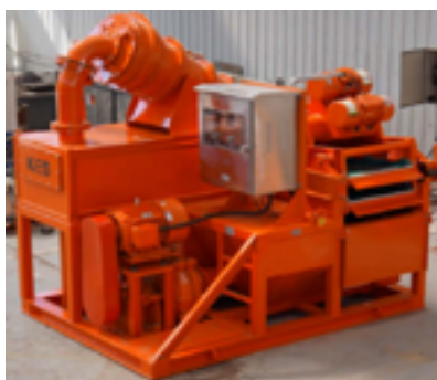
图 2-12 科盛能源泥浆泥水分离系统
