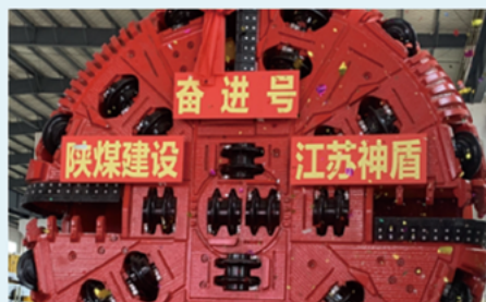
EQC5030全断面掘进机“奋进号”
