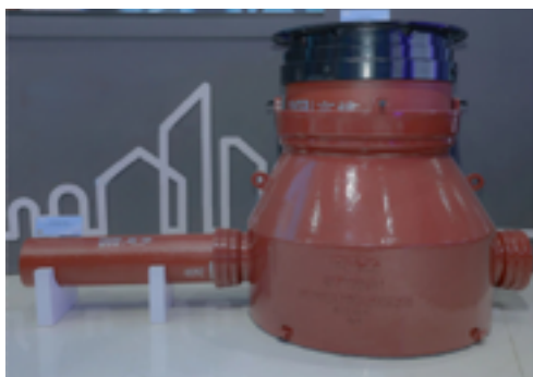
均为球墨铸铁材质 T型承插滑入式接口,密封性更强,同时可在 发生不均沉降时仍然保证密封性
