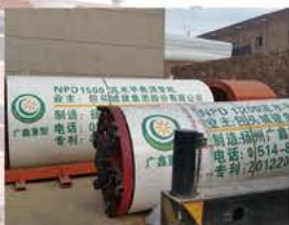
DN1500、1200泥水平衡顶管机
