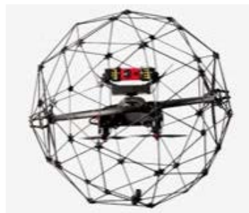
图 2-98 无人机检测设备
