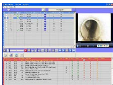
图 2-109 Wincan Viewer 管道缺陷自动分析软件界面
