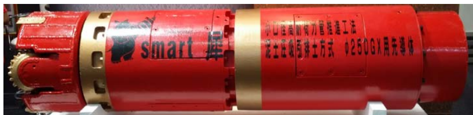
图 2-39 日本 250mm 微型顶管机
