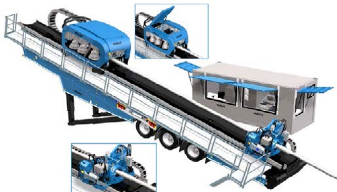
图 2-9 意大利 EGT 公司研制的电池驱动钻机
