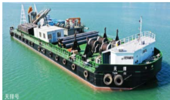
图 2-7 廊坊华元“天择号”HDD 专用钻探船
