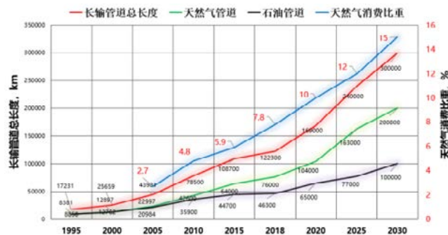
图 3-5 我国的长输管线建设情况
