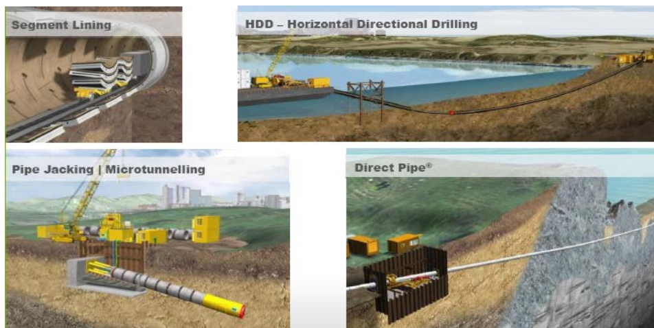
图 2-71 海岸管道工程非开挖施工方法
