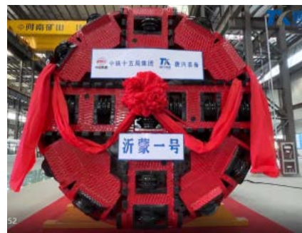
图 2-61 安徽唐兴沂蒙一号小直径硬岩泥水平衡盾构机
