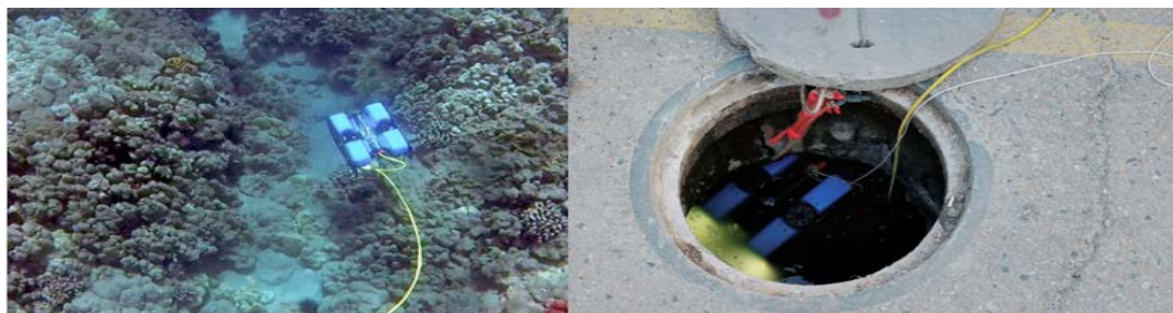
满水检测机器人
