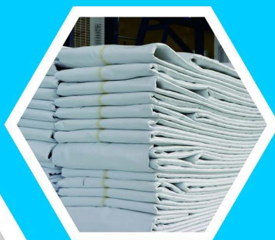
气压翻转法 (APFD) 修复内衬软管 适应范围：自来水管道路
