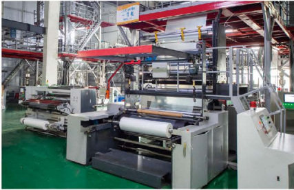
拥有薄膜产能约7000吨/年的七层共挤吹膜生产线，同时具有强大的仓储能力。
