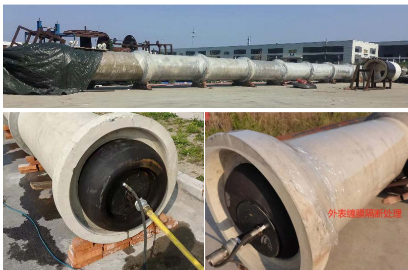
图 1 DN600 混凝土管道浸泡
