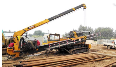
图 2 出土点徐工 360T 辅助钻机
