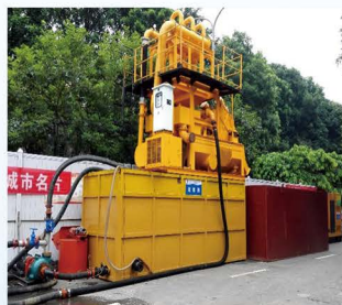
ZX-250用于顶管工程
