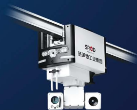
智能巡检机器人
