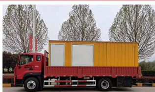
热塑成型管道内衬修复施工设备(静音型、普通型) 热塑施工车
