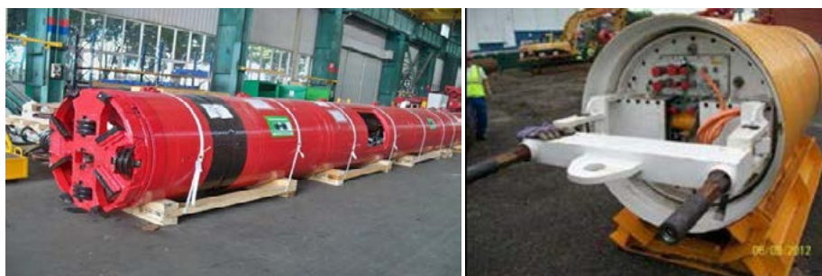
图 2-40 西气东输镇江高效园区改线工程直推管掘进设备与可回退式刀盘
