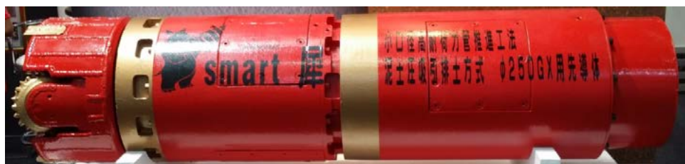
图 2-19 日本 250mm 微型顶管机
