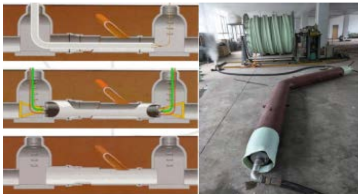
图 2-48 热塑料成型工法与试验
