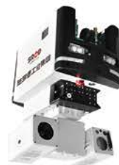
轨道巡检机器人
