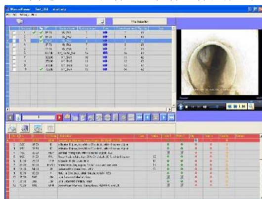
图 2-72 Wincan Viewer 管道缺陷自动分析软件界面
