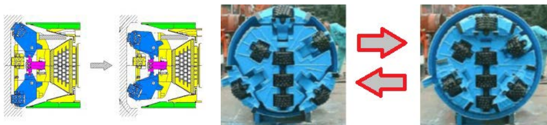
2-23 可撤回的顶管机机头
