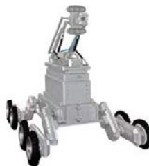
图 2-61 国产大型 CCTV 检测设备
