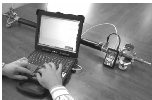
图 2-54 DUCT RunnerTm DR-HDD-4.2 惯性陀螺定位仪
