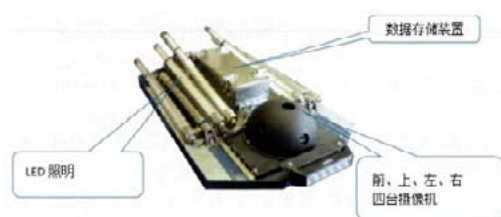
图 2-58 自漂流管道检测设备
