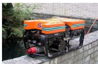
图 2-59 ROV Seamor 型潜水检测机器人
