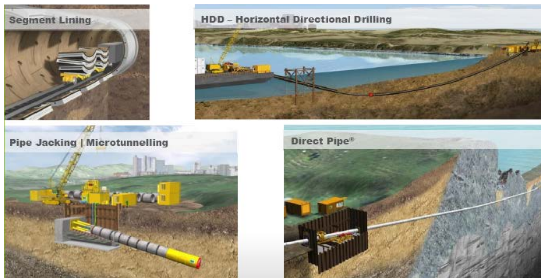
图 2-43 海岸管道工程施工方法
