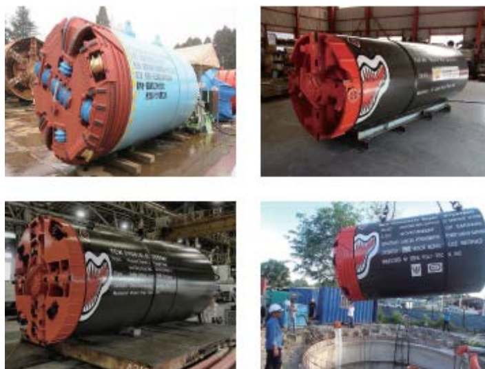
图 2-24 刀盘可转化的顶管机
