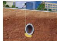
管道渗漏脱空诊治
