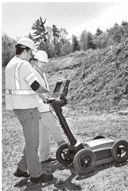
图1 使用探地雷达寻找加油站的地下储油罐
