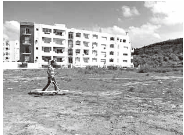
图 2 技术人员正在使用 GSSI Profiler EMP-400 频域的 EM 剖面测量系统, 这种剖面仪可以在距离地面障碍物 5 英尺以内使用, 可以用于定位金属目标, 也可以测量土壤电导率
