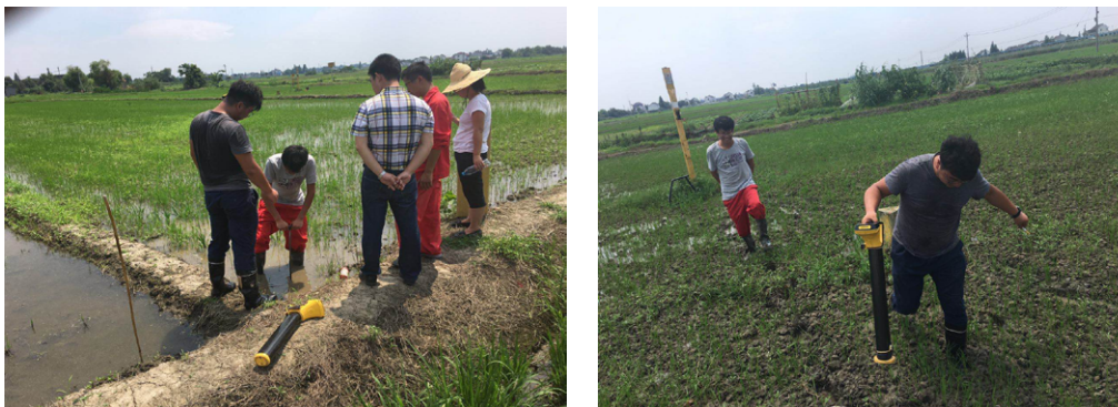
图（一）现场程工在连接发射机连接线，现场寻找最佳接地针插入点，调节发射机输出电流
