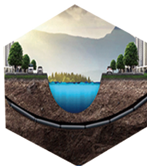
HDD水平定向钻施工剖面
