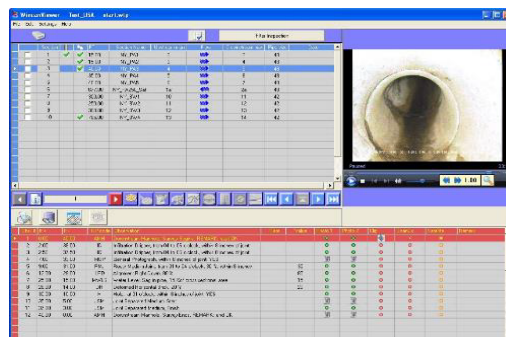
图 2-45 WincanViewer 管道缺陷自动分析软件界面
