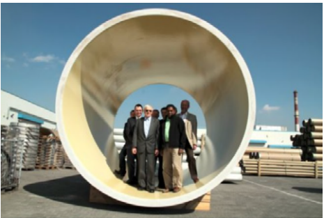
图 2-15 迄今为止 HOBAS 生产的最大的 CC-GRP 管道 (DN3600)
