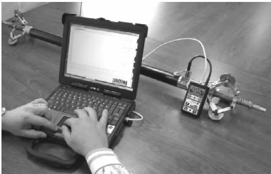
图 2-35 DUCT RunnerTrm DR-HDD-4.2 惯性陀螺定位仪
