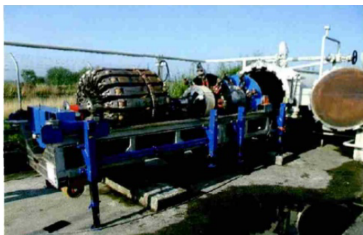
图 2-39 LineExplorer 3TM-tool 电磁超声检测器
